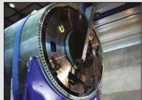
▲ Zirkulärfräsmaschinen für den Windkraftanlagenbau.
