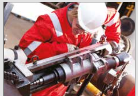
▲ Tragbare Bohrmaschinen mit hohem Drehmoment.
