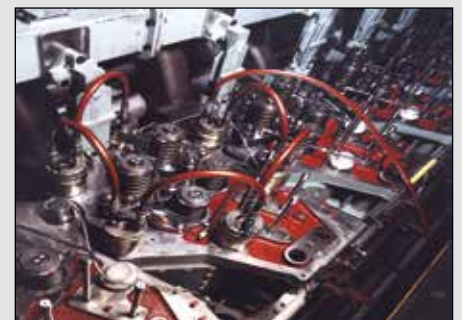
▲ Hydraulikmutter an einem Dieselmotor.
