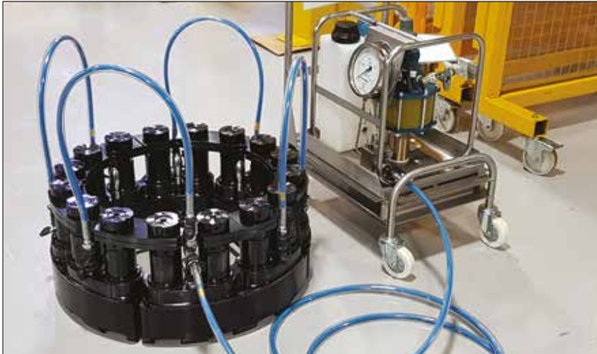
▲ Konfiguration für Vorspannen von mehreren Bolzen.
