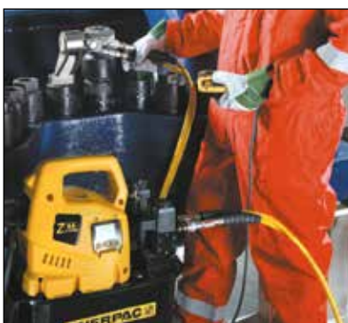
◀ Hydraulik-Drehmomentschlüssel jeder beliebigen Marke können mit den tragbaren Drehmomentpumpen der ZU4T-Serie betrieben werden
