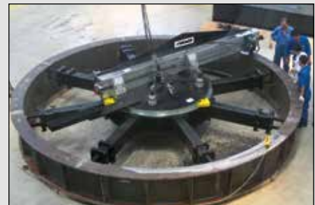
▲ Zirkulärfräsmaschinen für den Einsatz im Schiffbau und in der Energieerzeugungsindustrie.
