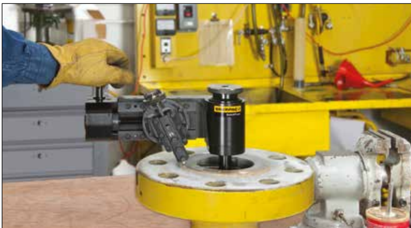
▼ Das Enerpac FF-120 beim Begradigen eines Rohrflansches.
