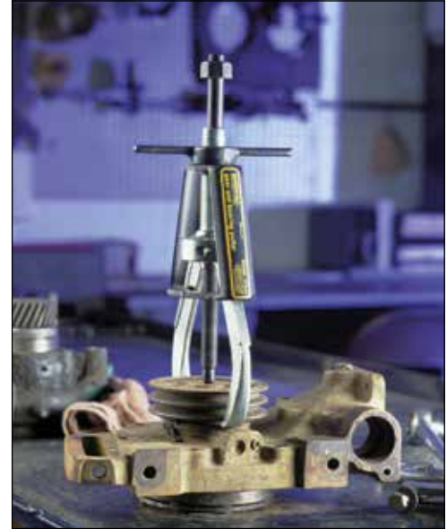
▲ Positionierung eines Abziehers mit 2 Klemmhaken EP-204, um die Antriebsscheibe einer Wasserpumpe abzunehmen.
