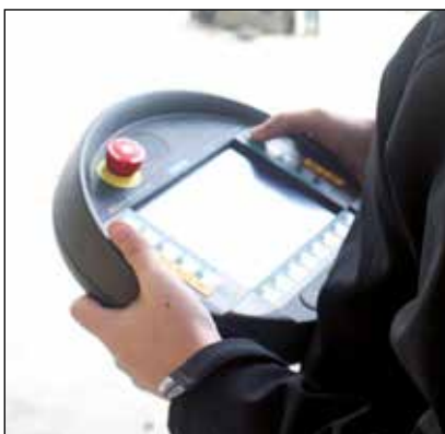
▼ Ein einzelner Bediener steuert und überwacht mit der drahtlosen Fernbedienung aus sicherer Entfernung den gesamten Hebevorgang.
