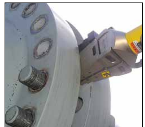
▼ Flansch-Wartung und Trennen von Verbindungen mit dem Hydraulik-Spreizwerkzeug FSH-14.
